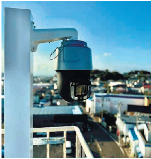
地上17層から市街地を撮影して火災を発見するAI（人工知能）カメラ＝大洗町消防本部提供
